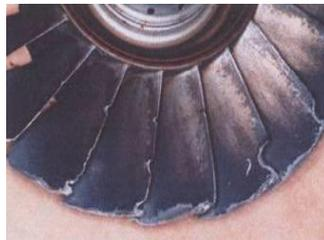
FIGURE 1. AERO-ENGINE COMPRESSOR BLADE EROSION
