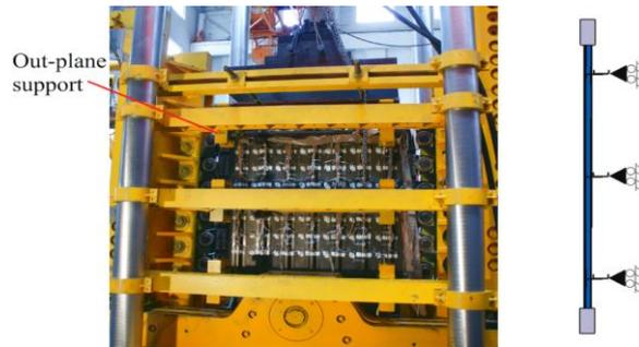
FIG.4 OUT-OF-PLANE CONSTRAINTS OF FRAME ENDS
