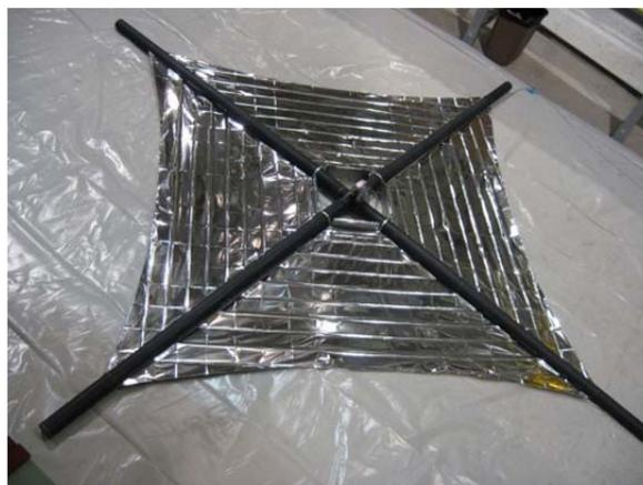
FIG.7 MAGSAIL GROUND PROTOTYPE
